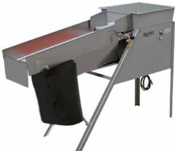
Trennrost 400 mm stationär, elektrischer Antrieb
