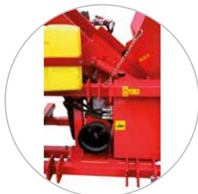
Bild zeigt die eigene Hydraulik am **FRD** inkl. Ölkühler 12 V (optional, Bausatz, für Traktoren mit einer Ölpumpenleistung von unter 40 l/min)
