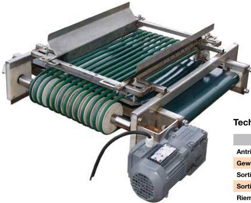
Beschädigte, zu kleine Früchte werden mittels konisch laufenden Rundriemen aussortiert und über ein Quertransportband seitlich ausgegeben. Die Weiteneinstellung der Rundriemen ist über auswechselbare Distanzbuchsen exakt einstellbar.
