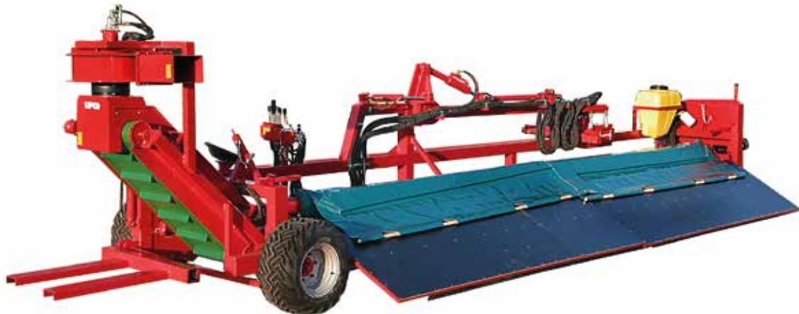
Das leistungsstarke, kompakte Schüttelaggregat und die **sehr baumschonende Zange** ist Standard bei allen Schüttelgeräten.
