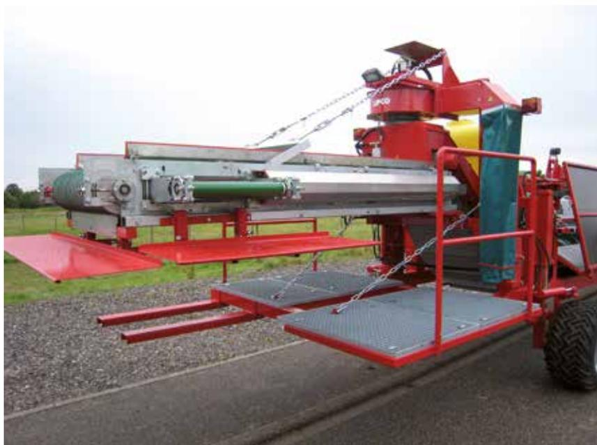
**SB-020** auf **LIPCO AES**, mit seitlicher Hubgabel für Ausschuss in Großboxen, mit Durchschiebeblech für Sortiergrößen und mit beidseitigem Podest für manuelle Vorsortierung
