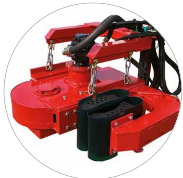
kompakte Industriezange mit 4-Punkt-Kettenaufhängung
